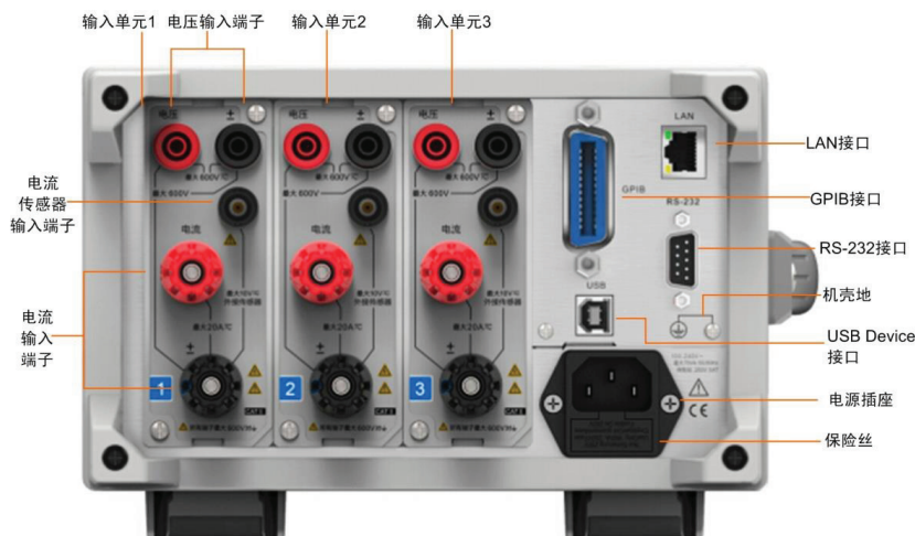
图 3.23 PA323 型功率计后面板描述
