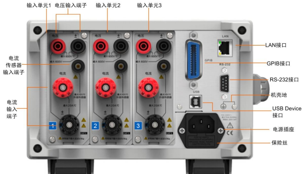
图 3.24 PA323 型功率计后面板描述
