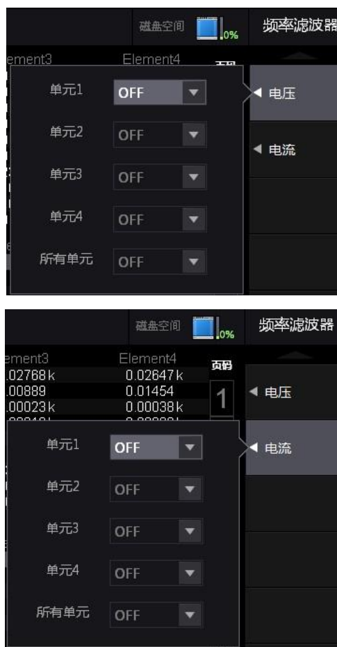
图 5.19 开启/关闭频率滤波器
