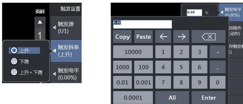
图 6.31 触发斜率和触发电平
