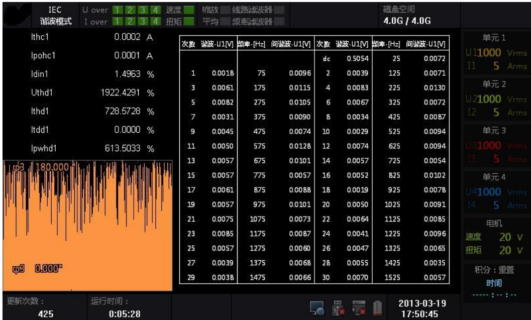
图 2.11 IEC 谐波测量所有视图
