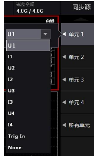
图 5.21 选择须配置同步源的输入单元
