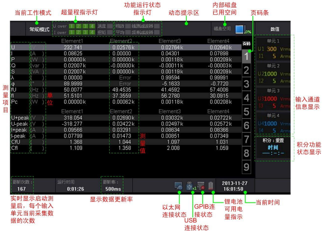
图 3.2 常规测量模式下的屏幕显示实例
