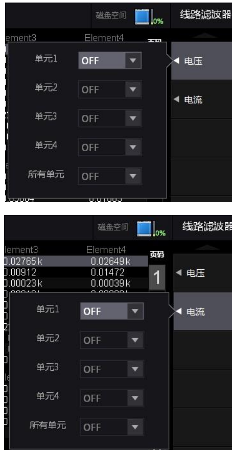
图 5.17 选择须配置线路滤波器的对象单元
