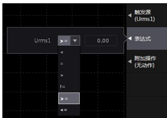
图 5.28 常规数据触发类型下的触发条件
