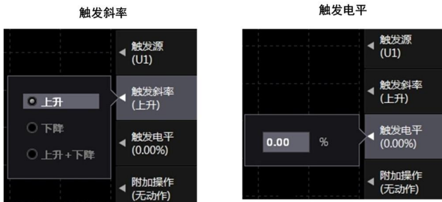
图 5.27 原始数据触发类型下的触发条件
