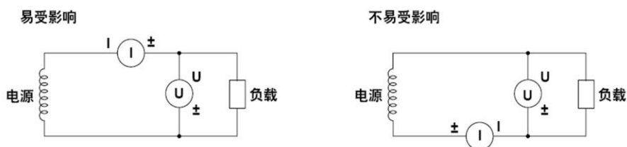
图 5.33 降低杂散电容对测量精度的影响
