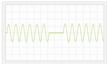
线路编程 (Sim) 仿真电压突降输出
