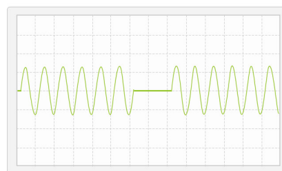
线路编程 (Sim) 仿真电压突降输出
