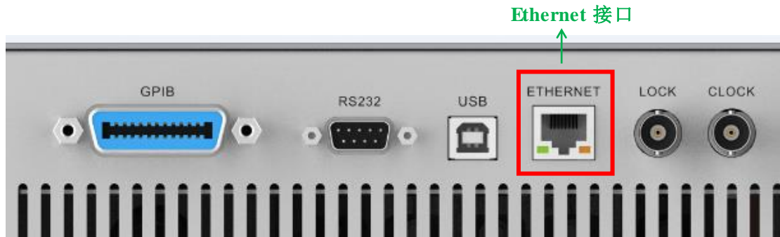
图 7.6 交流电源 Ethernet 接口
