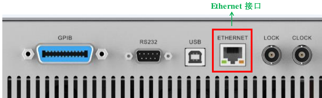
图 6.6 交流电源 Ethernet 接口
