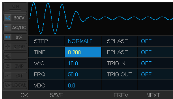
图 5.29 正常供电状态设置界面
