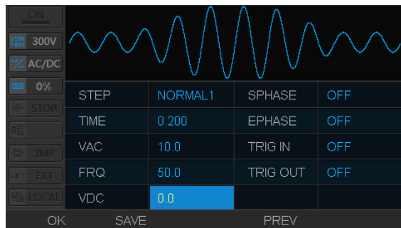
图 5.33 正常供电状态 1 设置界面
