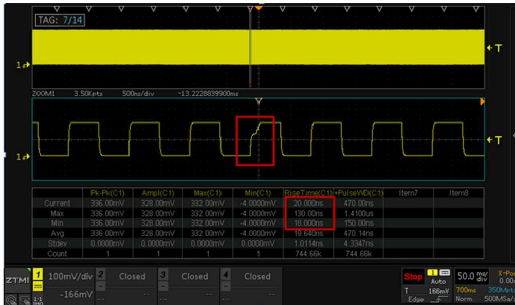
图 3 测量统计+搜索标注捕获上升沿异常波形
