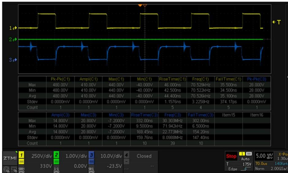
图 1 VGS、VDS 测量参数
