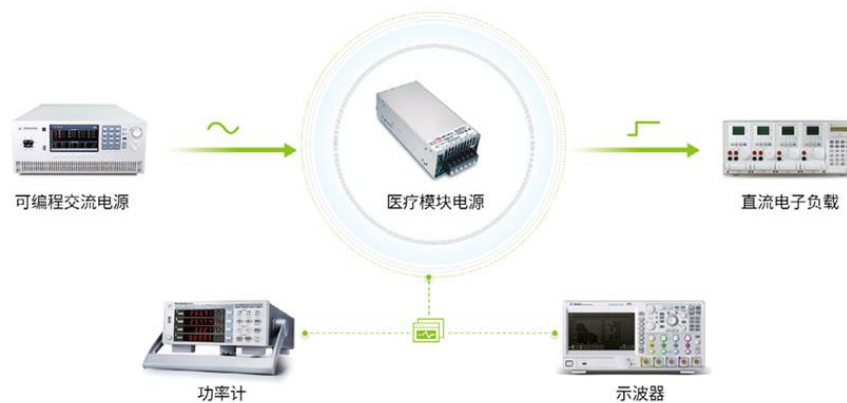
图 1 医疗电源模块的测试拓扑图
