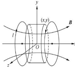
其通过一对彼此平行且同轴的圆形连通线圈，且两线圈间距与圆线圈半径相同，使两线圈内通过方向一致且大小相同的电流，其公共轴中点附近产生较广的均匀磁场。在一维磁场的基础上，还可进行二维、三维组合磁场的叠加，**可提供交流磁场或直流磁场，并且电流和磁场具有非常稳定的线性关系。**
