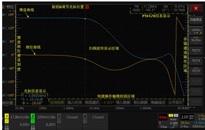
图9 示波器环路测试
