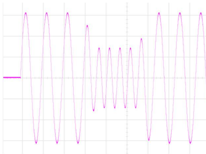
图8 线路仿真模式----模拟供电某段异常输出
