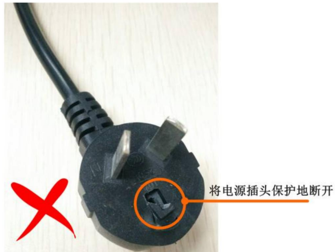
图 1-1 示波器电源插头地线断开
