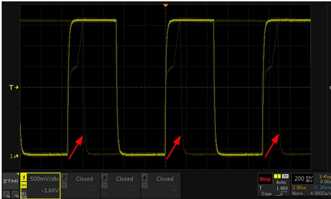
图3 ZDS5054Pro 示波器捕获异常信号
