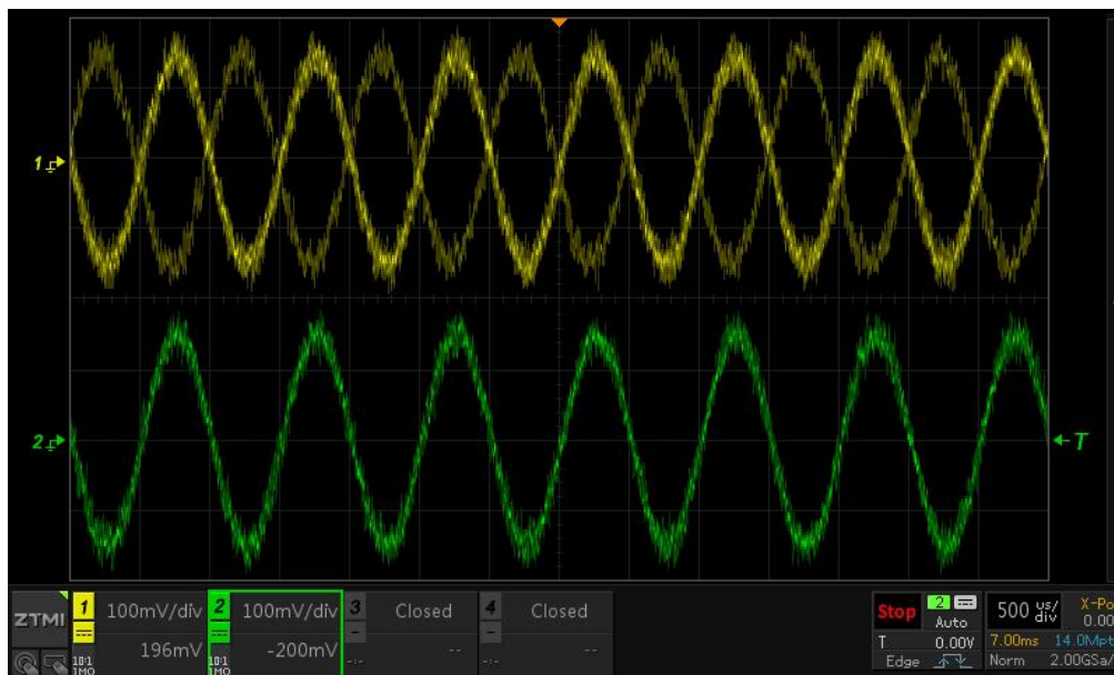
图5 CH1 不开启高频抑制触发不稳，CH2 开启高频抑制
