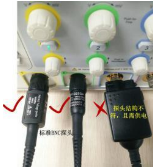
图 8 示波器与探头结构不匹配
