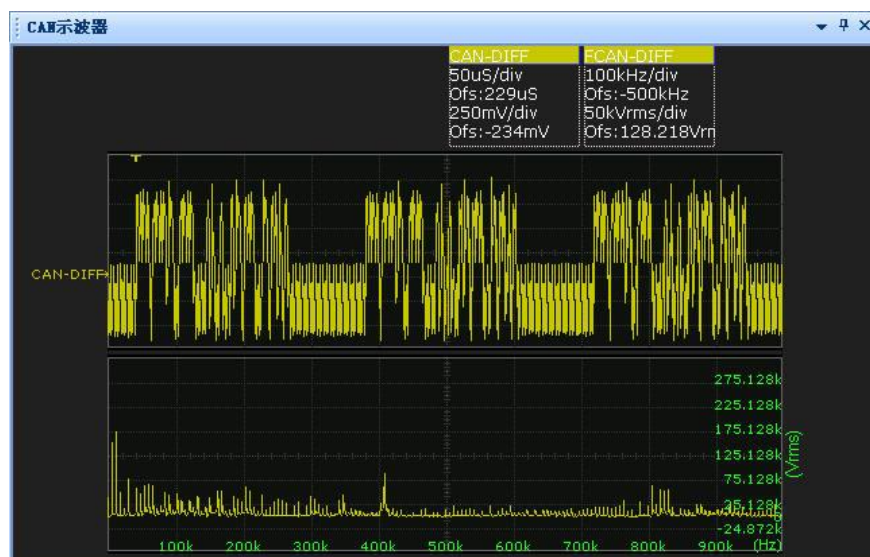
图 8.67 加入干扰频率的差分信号 CAN_DIFF 的波形及其 FFT 分析
