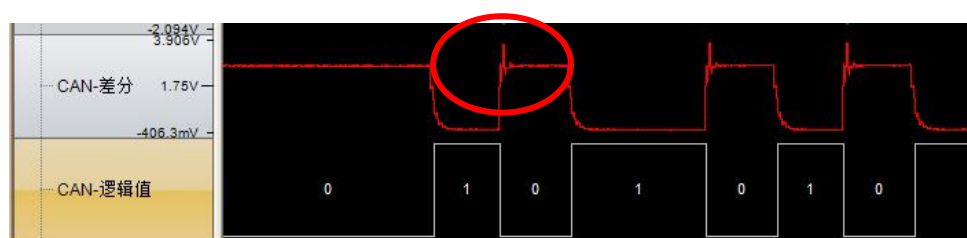
图 8.83 斜率过大导致 EMI 超标
