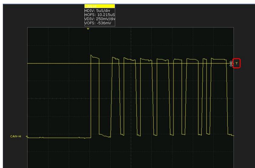
图 8.11 触发电平位置
