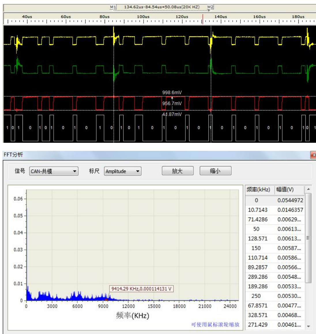
图 8.73 周期性脉冲干扰 FFT 无法分析
