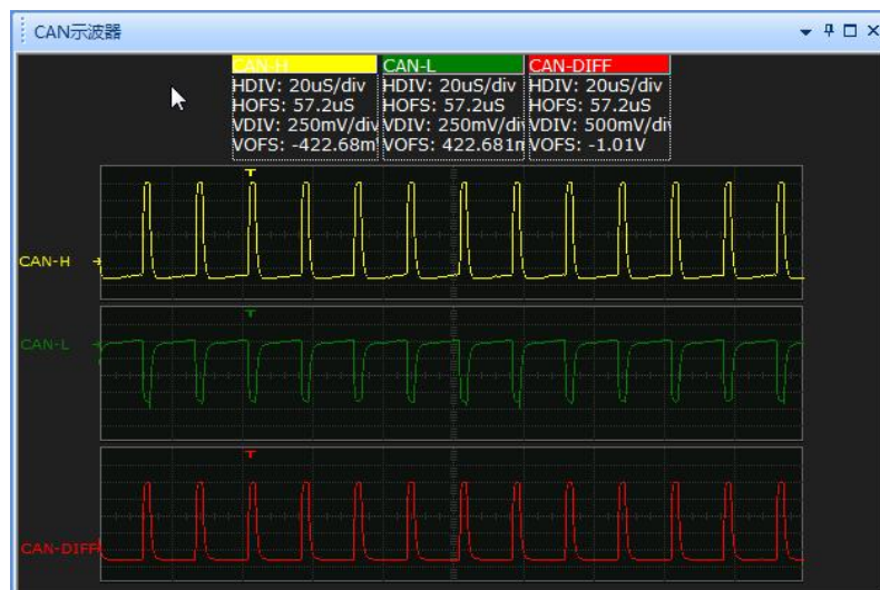
图 8.102 CAN 示波器_ CHL (4000pf) 测试结果
