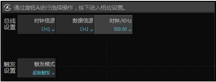
图 2.2 MIPI-RFFE 解码参数设置
