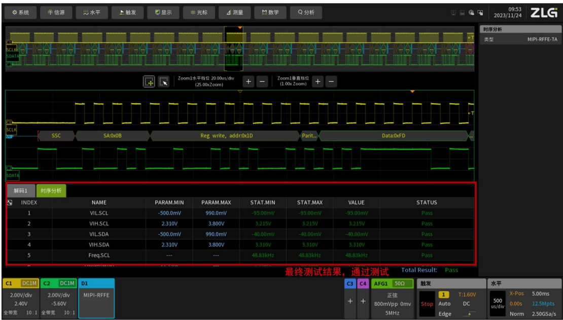
图 2.20 MIPI-RFFE 时序分析测试结果
