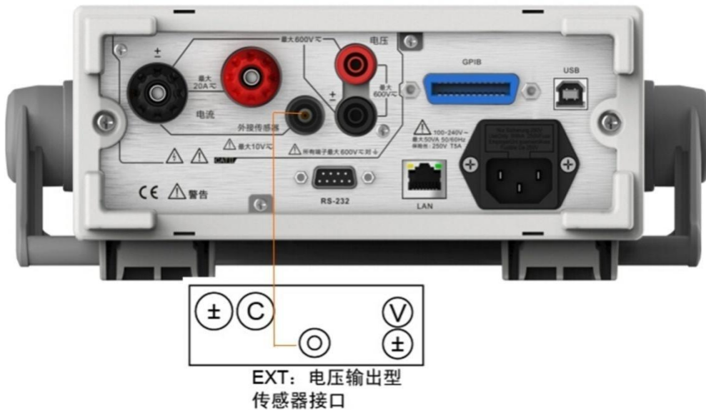
图 4.11 外部电流传感器端子符号
