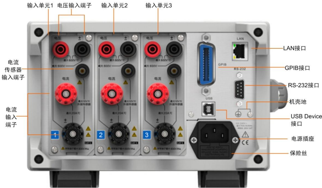
图 3.19 PA323 型功率计后面板描述
