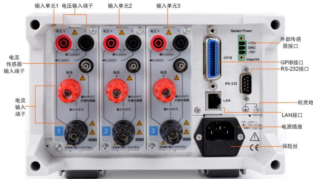
图 3.20 PA333H-2K 型功率计后面板描述
