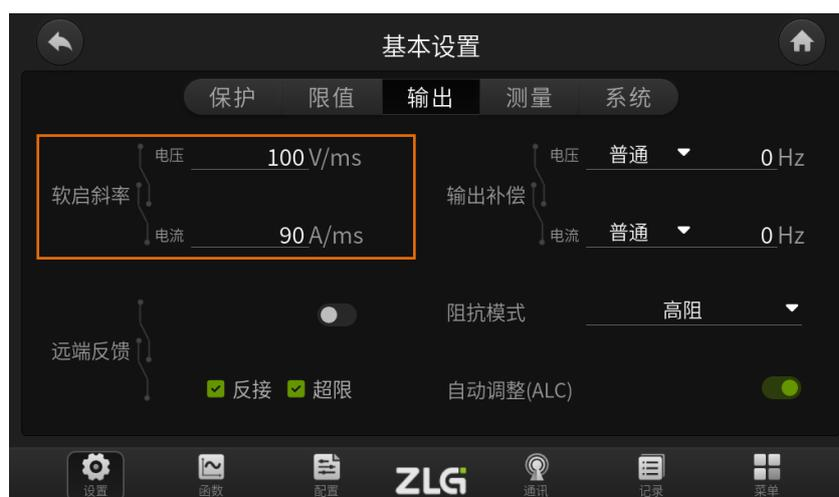
图 6.3 输出斜率设置
