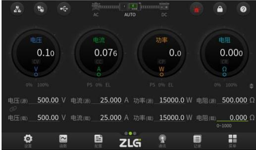
图 5.25 源的输入功率限值界面
