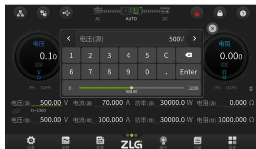
图 5.18 输出电压值设置界面
