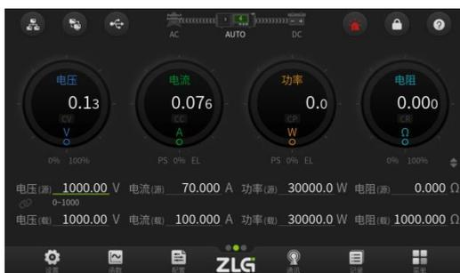
图 5.17 输出电压限值界面
