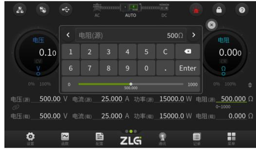
图 5.24 源的输出功率设置界面
