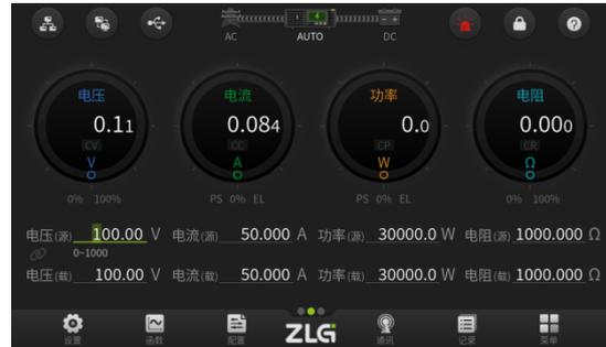
图 5.36 旋钮 B 短按调整电压（源）百位数的数值
