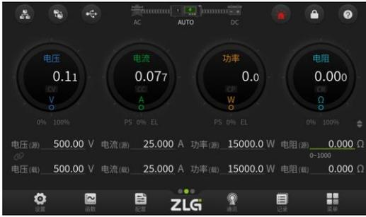
图 5.23 载的输出功率限值界面
