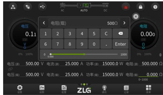
图 5.30 载的输入电阻值设置界面
