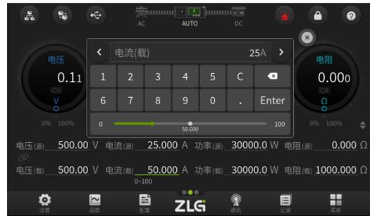
图 5.22 载的输入电流值设置界面
