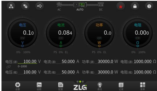
图 5.35 旋钮移至电压（源）参数选中
