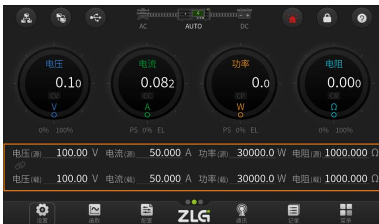
图 5.34 旋钮 B 仅可框选的参数栏
