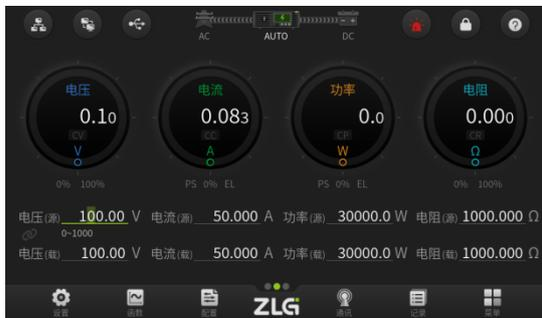
图 5.37 旋钮 B 再按调整电压（源）十位数的数值
