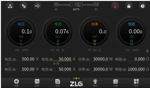
图 5.19 源的输出电流限值界面
