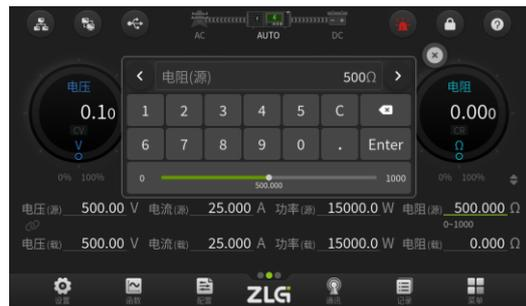
图 5.28 源的输出电阻值设置界面
