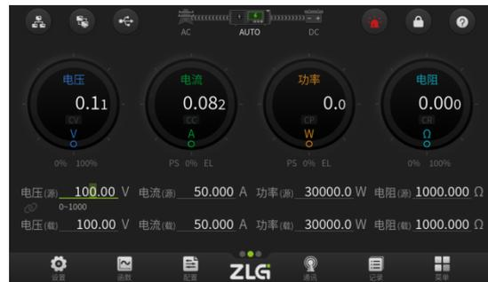
图 5.38 旋钮 B 又再按调整电压（源）个位数的数值
