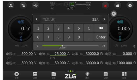
图 5.20 源的输出电流值设置界面
