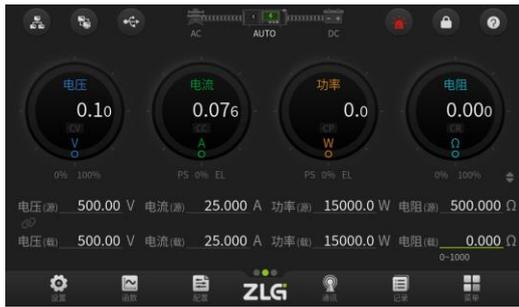
图 5.29 载的输入电阻限值界面
