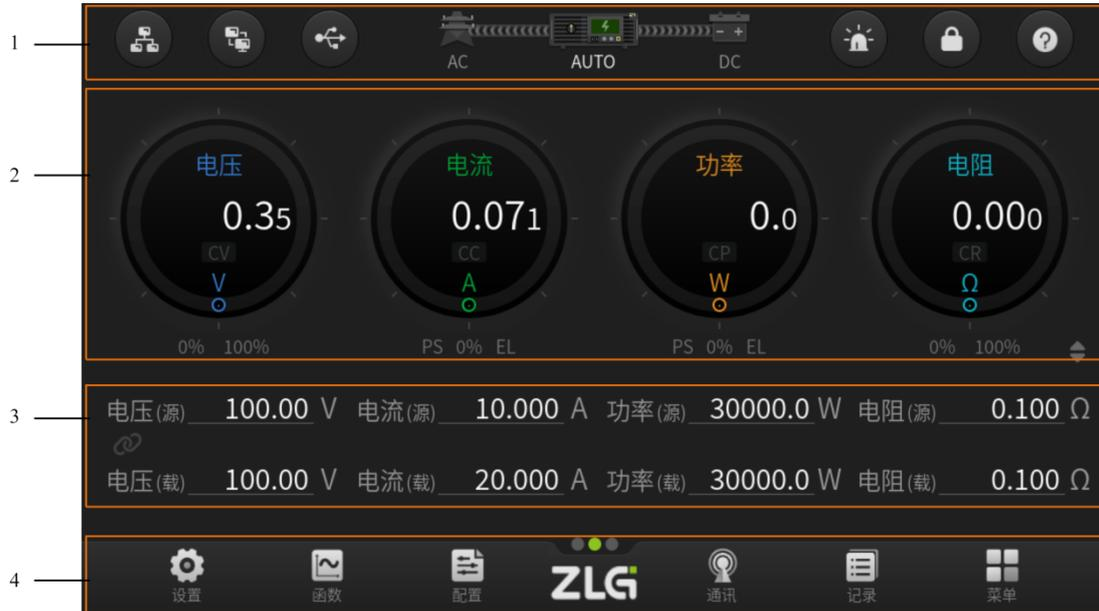
图 2.3 PSB8000 系列双向直流电源显示面板
