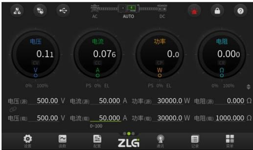
图 5.21 载的输入电流限值界面
