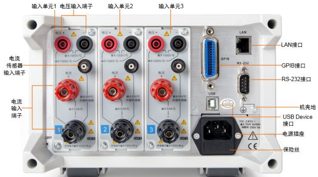
图 2.22 PV300 型功率计后面板描述
