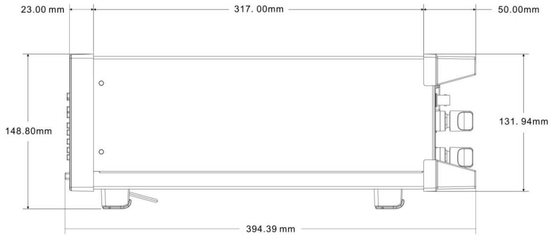
图 7.2 PV300 功率计机械尺寸图（侧面）
