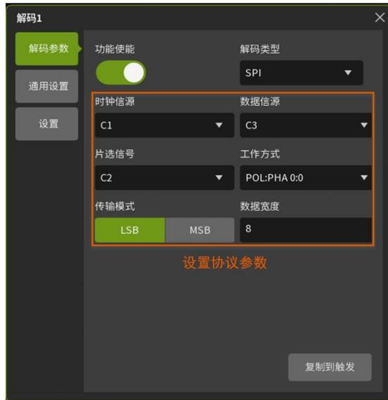
图 2.14 SPI 解码参数设置
