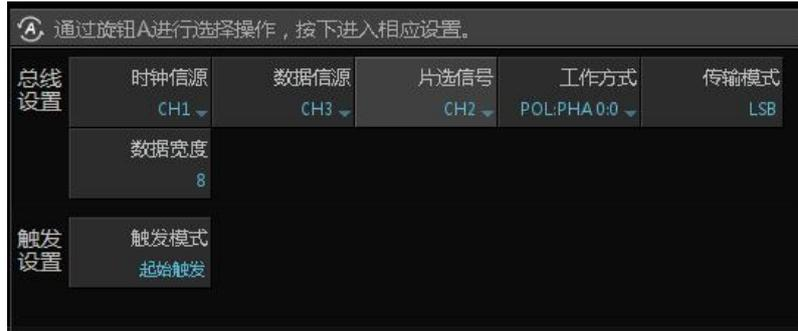
图 2.2 SPI 解码参数设置
