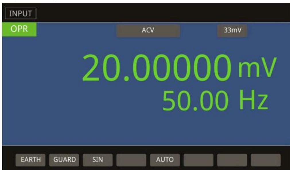
图 4.2 20mV 交流电压输出显示界面
