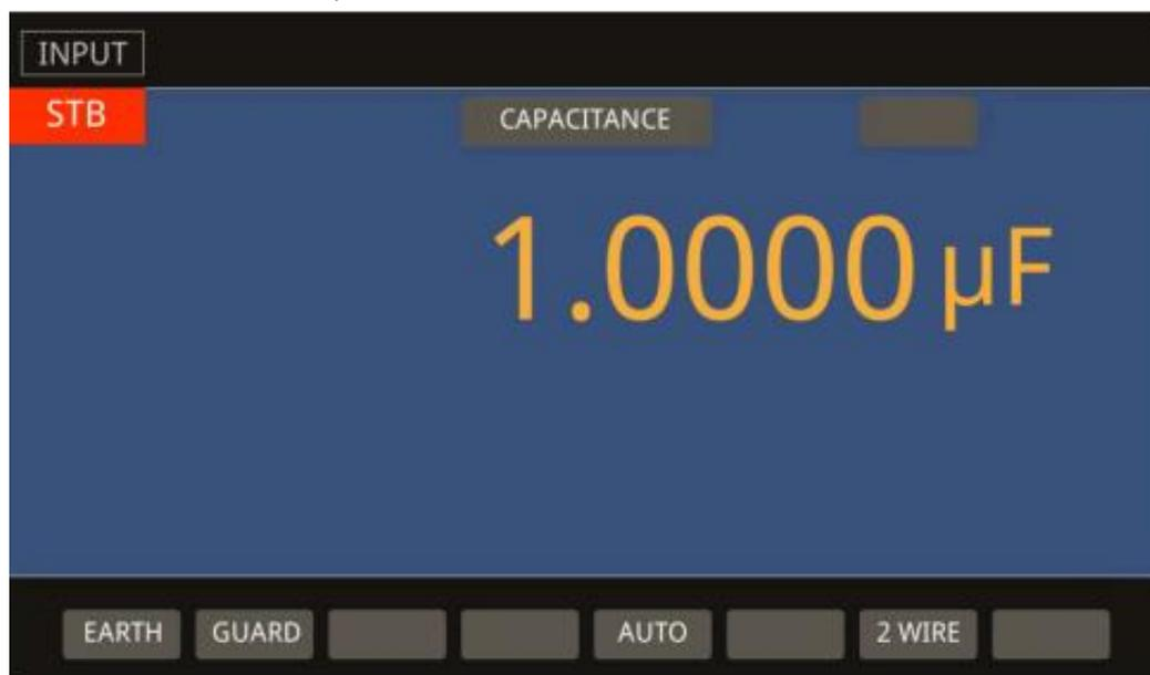
图 4.6 模拟电容输出操作界面
