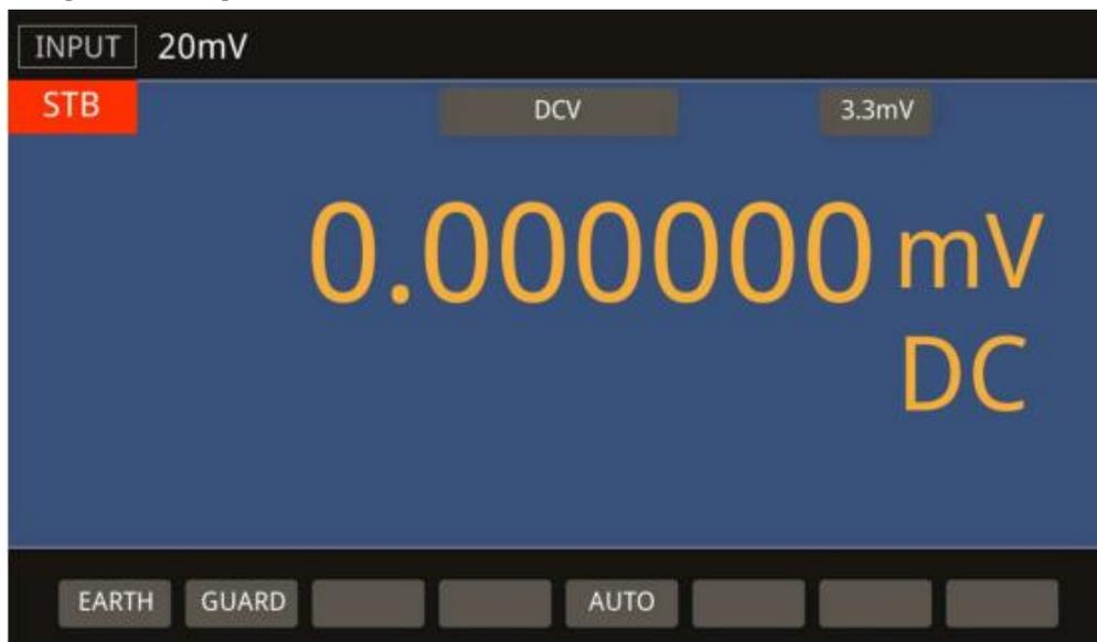
图 4.1 20mV 直流电压操作设置界面
