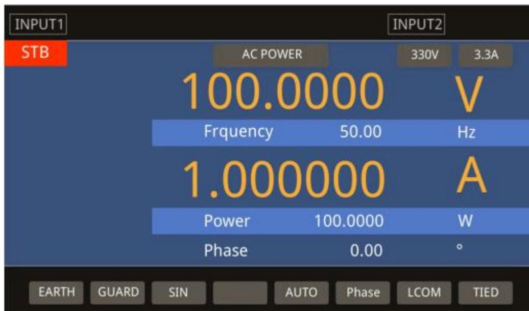
图 4.4 100V/1A 交流功率操作显示界面
