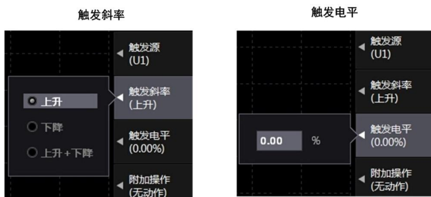
图 5.27 原始数据触发类型下的触发条件
