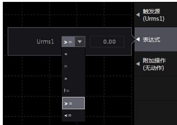
图 5.28 常规数据触发类型下的触发条件
