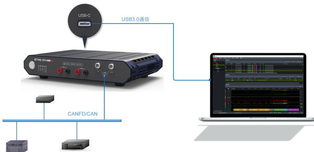
图 4.1 ZPS 硬件测试连接框图
