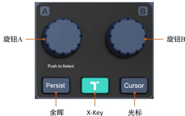
图 5.10 多功能旋钮区面板
