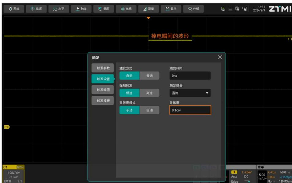
图 10.20 掉电波形稳定捕获
