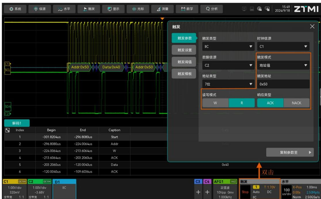
图 15.32 I<sup>2</sup>C 触发设置
