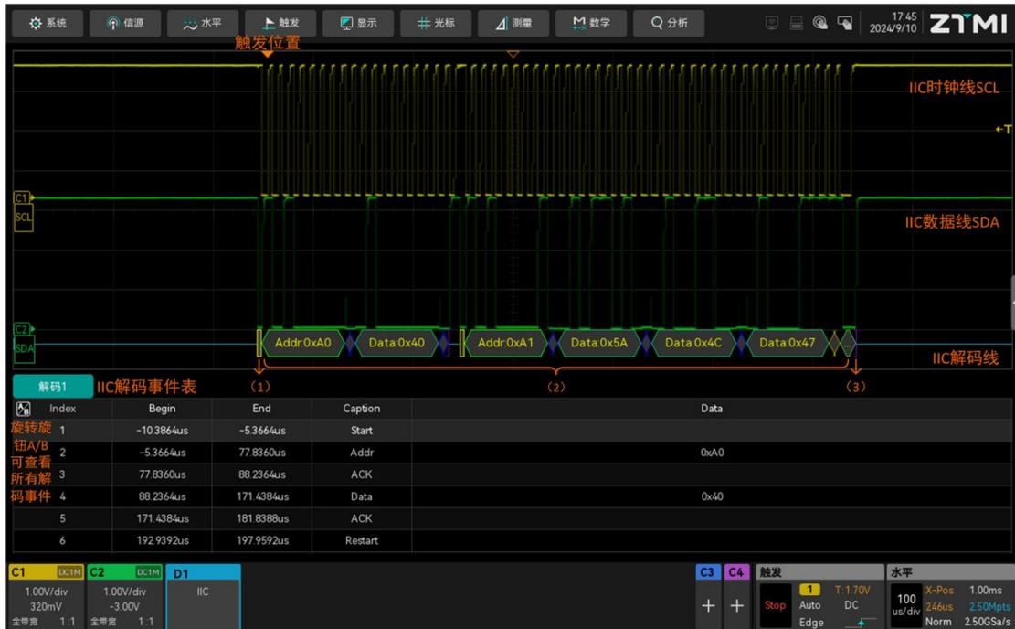
图 15.1 解码功能示意（ZUS5054Pro 型）
