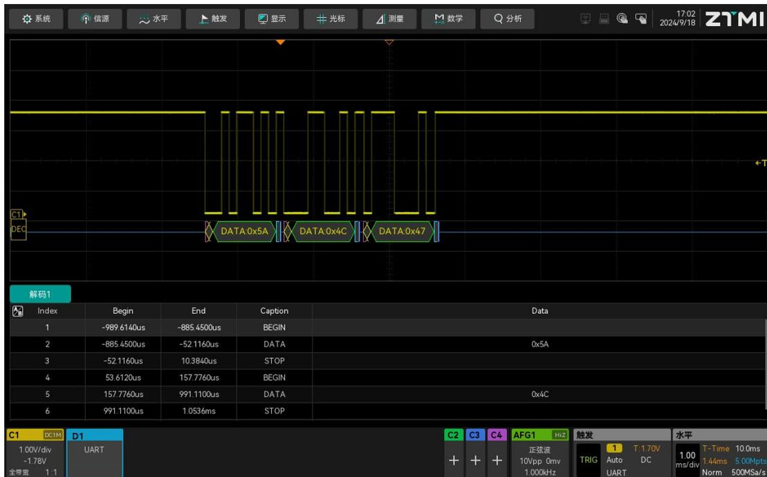
图 15.46 UART 协议触发与解码
