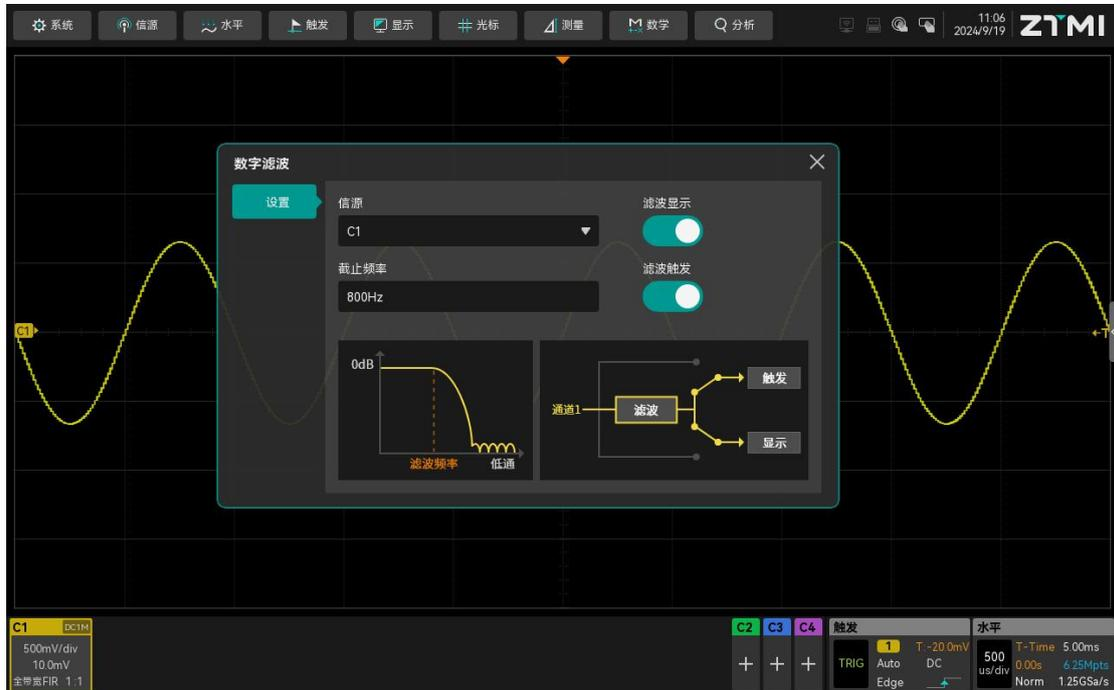
图 16.3 滤波触发和显示
