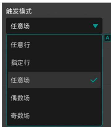
图 10.47 视频触发模式设置
