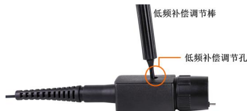
图 5.7 探头补偿调节孔
