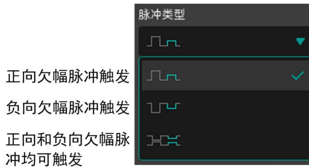
图 10.30 欠幅触发的脉冲类型
