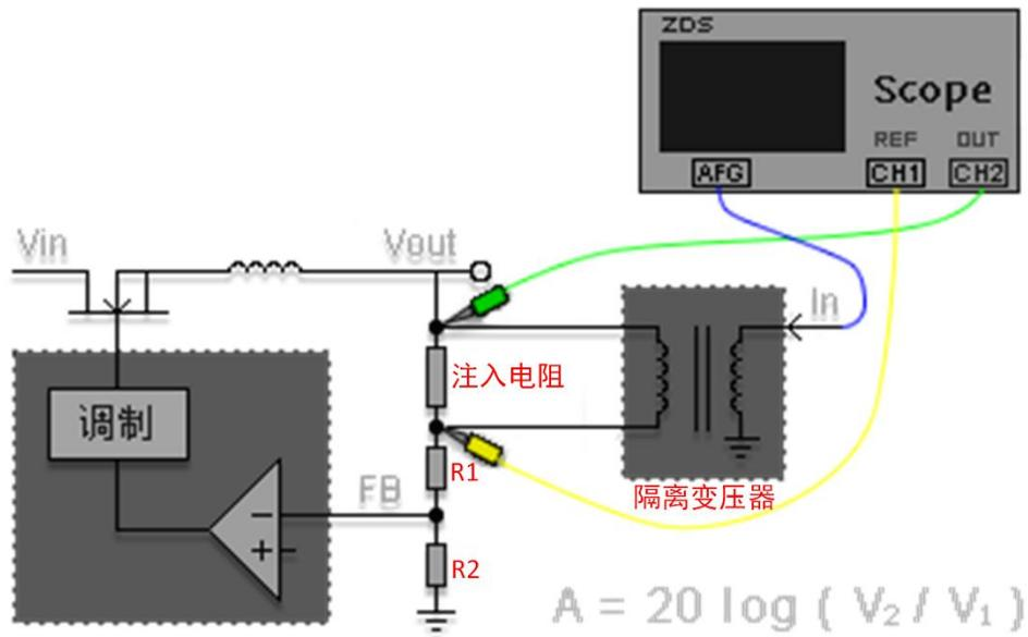
图 3.5 ZDS5000、ZUS6000 环路测试信号接线（同步测试）
