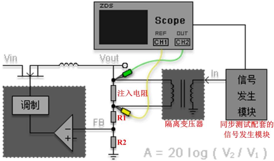
图 3.3 ZDS4000 环路测试信号接线（同步测试）
