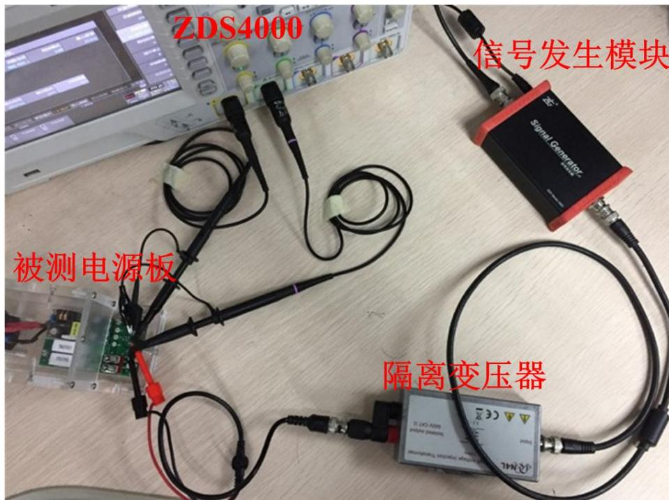
图 3.4 ZDS4000 同步测试实物连接
