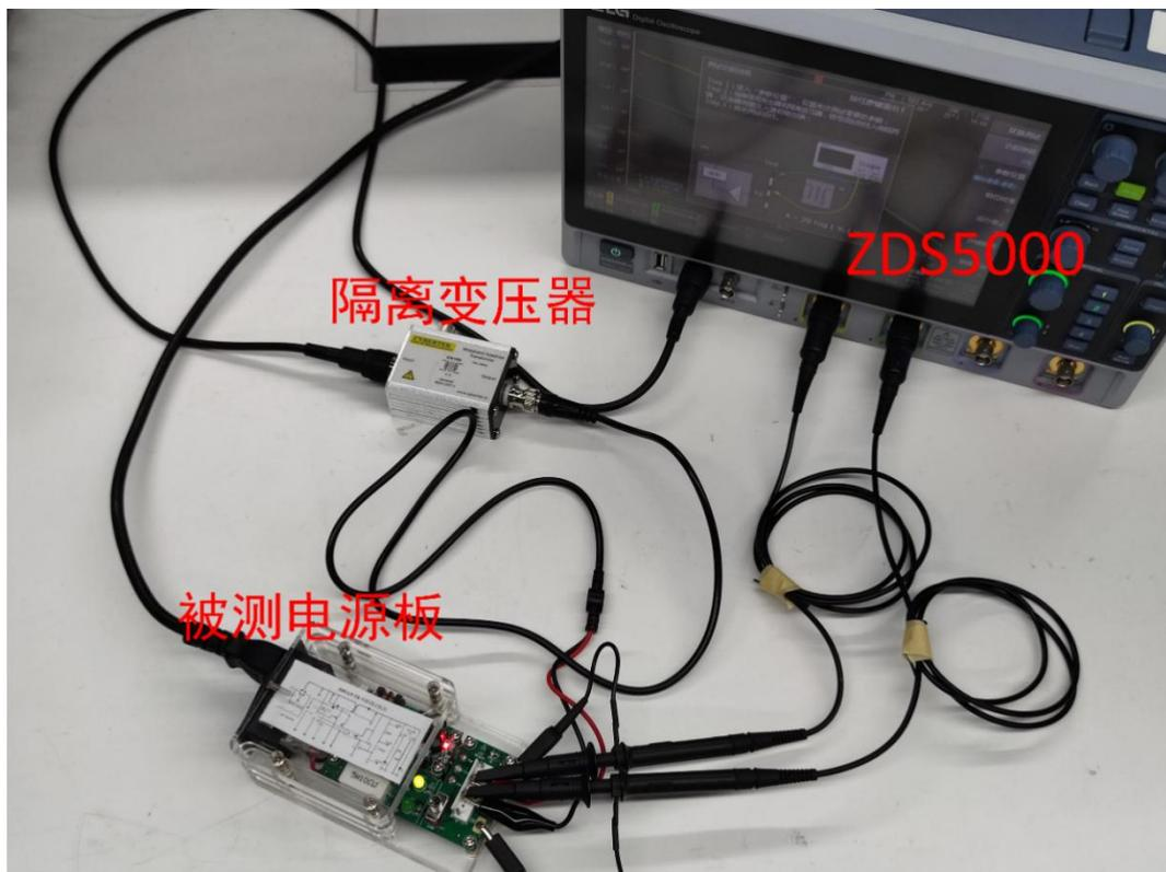
图 3.6 ZDS5000、ZUS6000 同步测试实物连接
