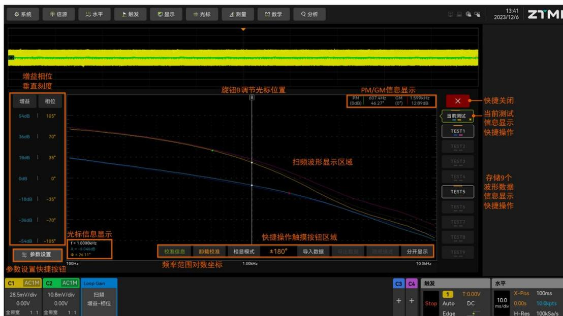
图 5.4 环路测试的扫频操作界面
