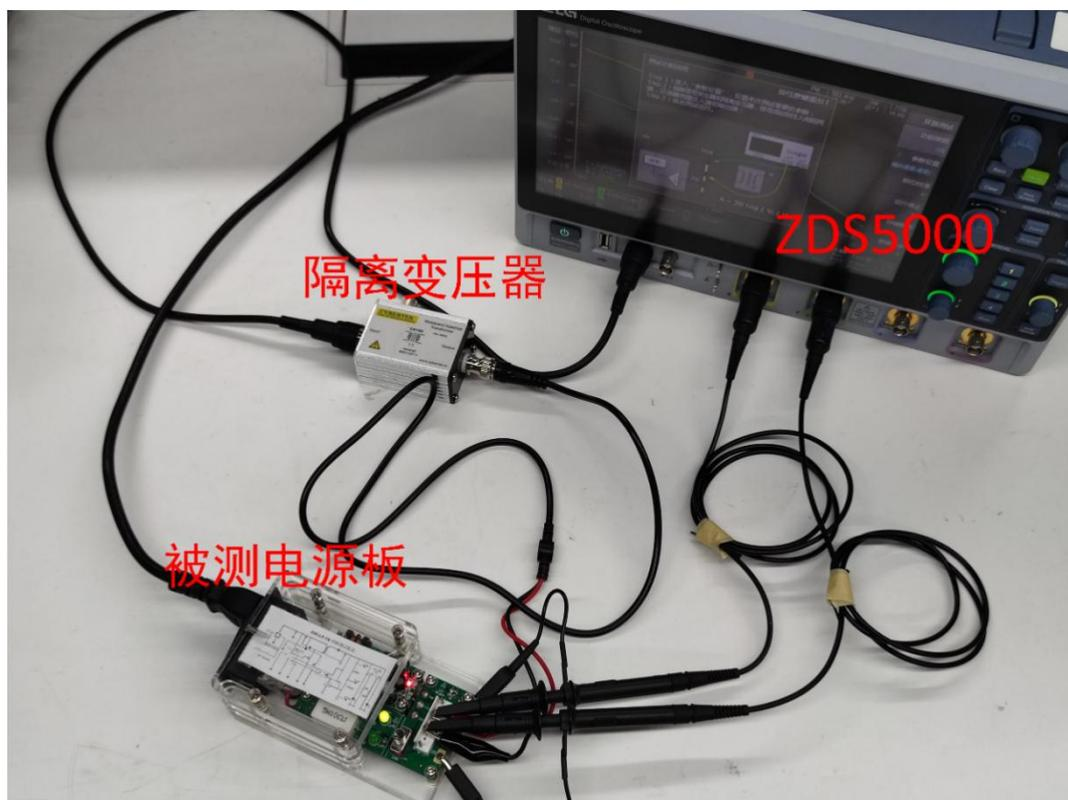
图 2.4 ZDS5000、ZUS6000 同步测试实物连接
