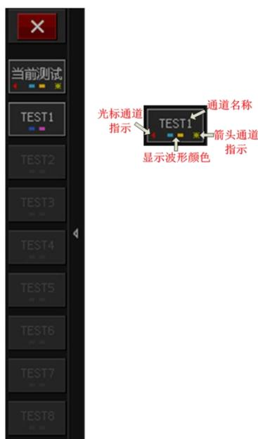
图 2.13 存储通道的显示和操作区域
