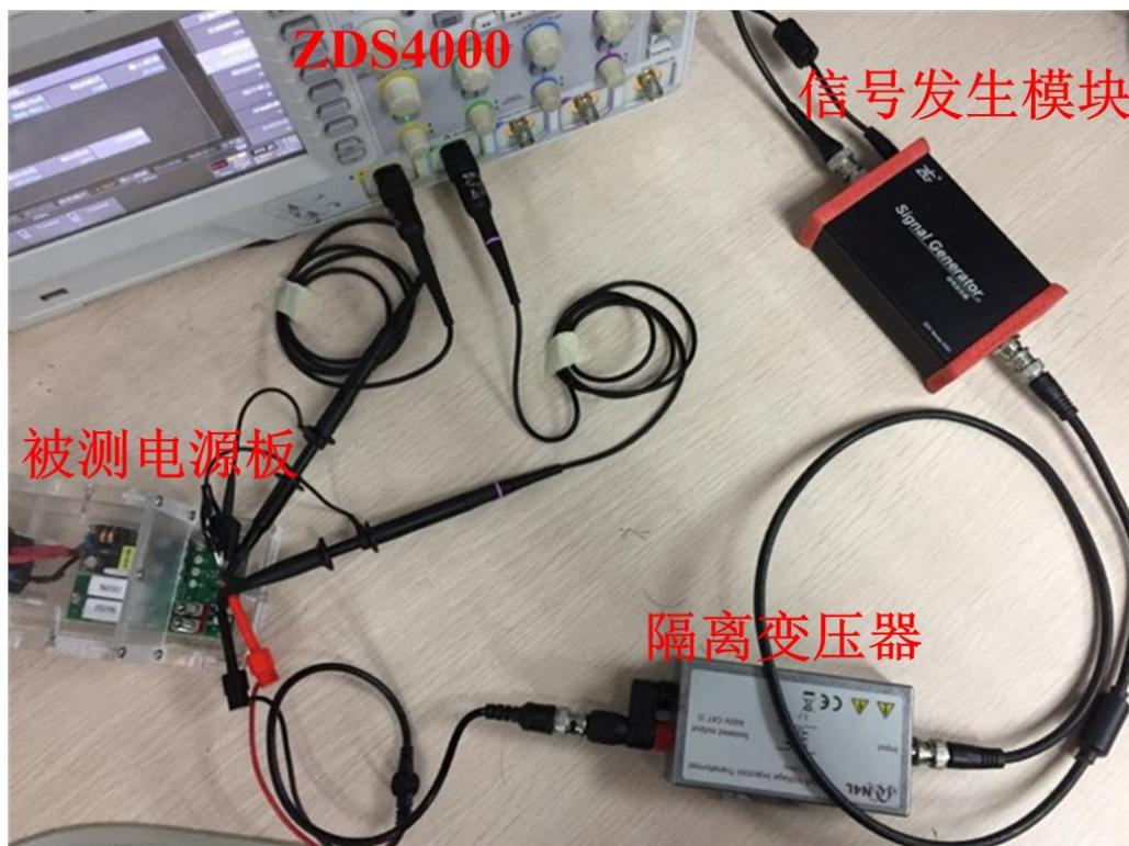
图 2.2 ZDS4000 同步测试实物连接
