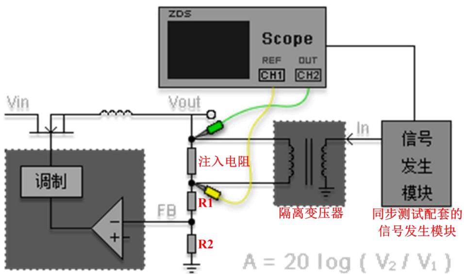
图 2.1 ZDS4000 环路测试信号接线（同步测试）
