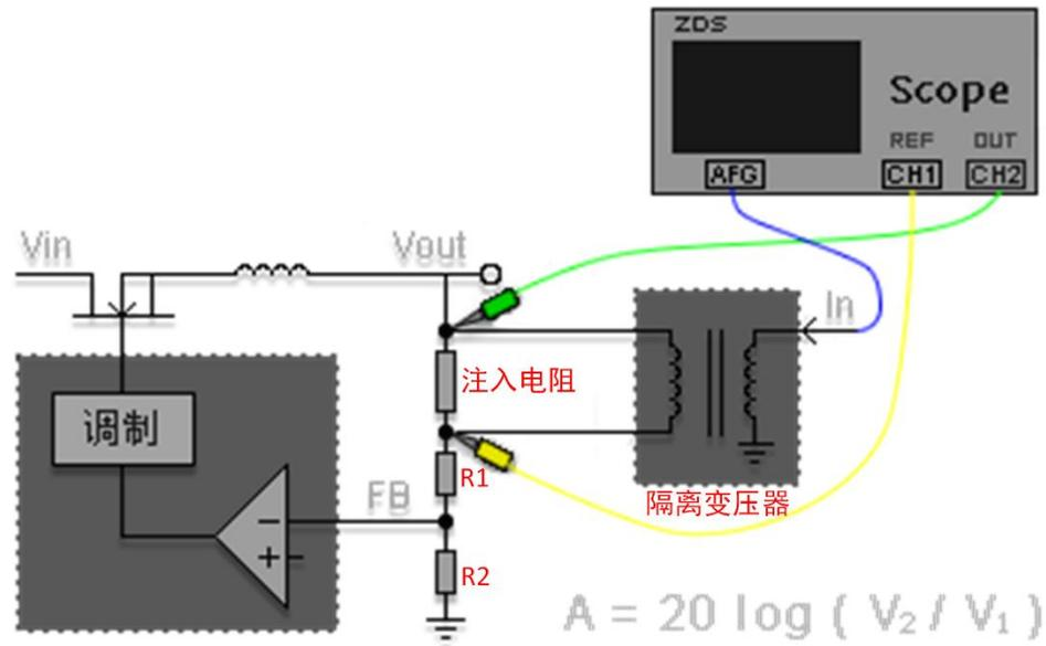
图 2.3 ZDS5000、ZUS6000 环路测试信号接线（同步测试）
