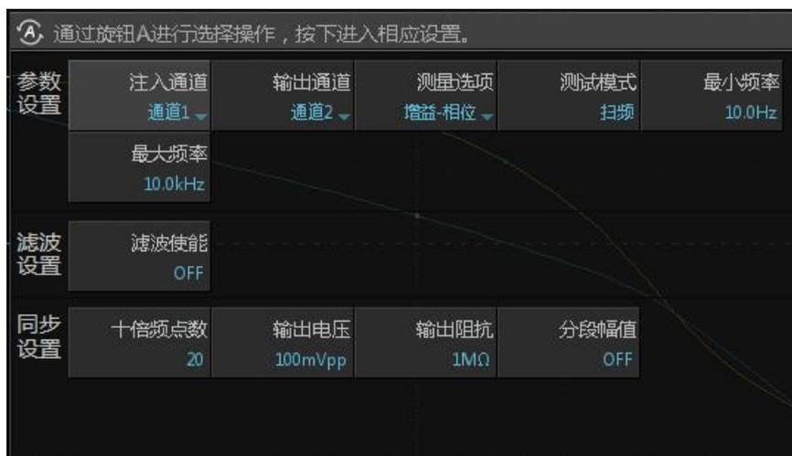
图 2.9 同步模式的参数设置
