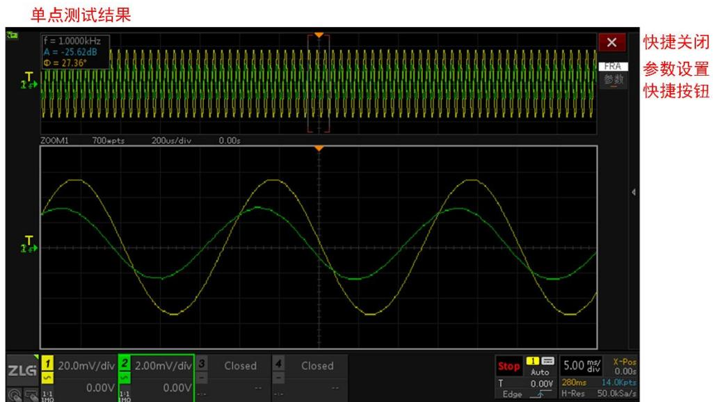
图 4.5 环路测试的单点操作界面
