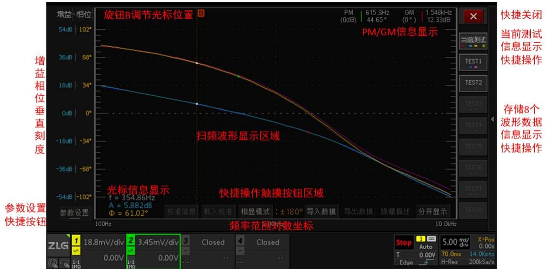
图 4.4 环路测试的扫频操作界面
