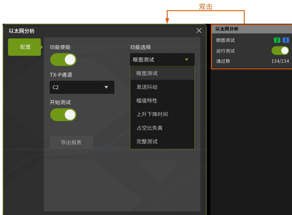
图 2.4 ZUS6000 切换以太网分析功能
